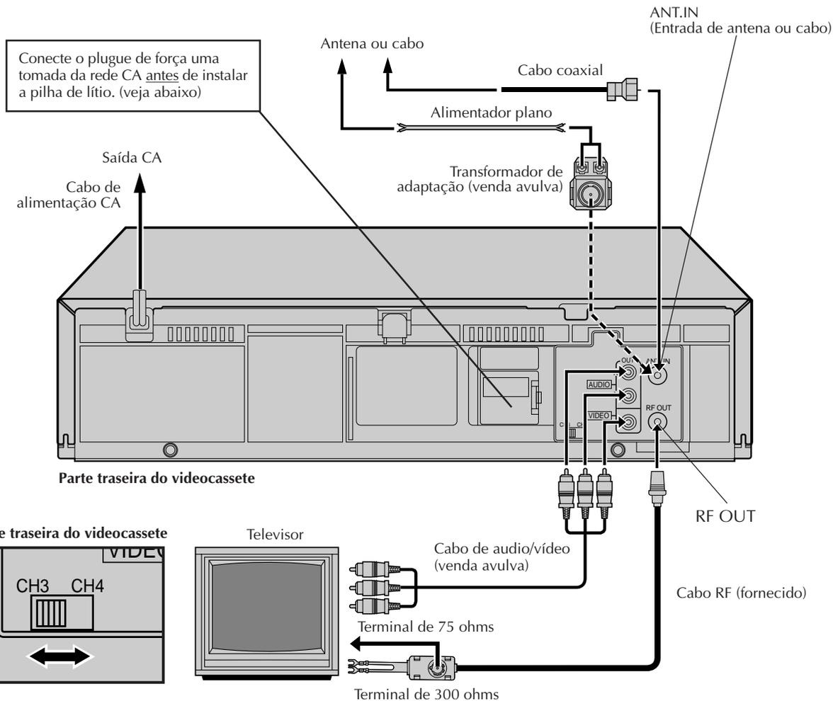
Certifique-se de conectar o plugue de força a uma tomada da rede elétrica primeiro, antes de instalar a pilha de lítio; do contrário, a vida útil da pilha será drasticamente encurtada.
